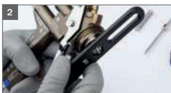
2 Затяните форсунку вручную, используя универсальный гаечный ключ
