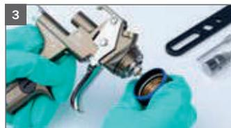
3 Открутите наконечник с помощью накидного гаечного ключа, встроенный в универсальный гаечный ключ.
